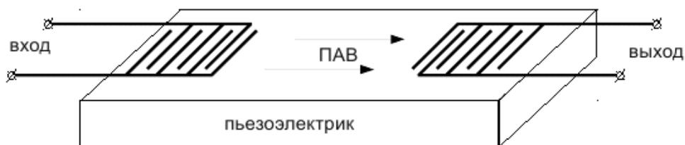
Рис.1. Преобразователь на поверхностных акустических волнах
