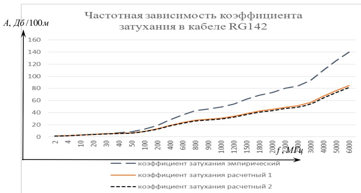
Рис. 4. Графики коэффициентов затухания кабеля RG142.
