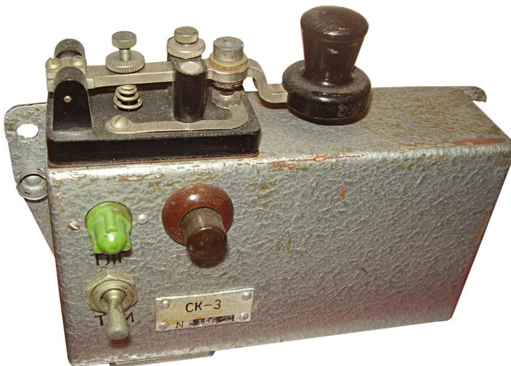
Рис.34. Телеграфный ключ из кабины тренажёра космического корабля «Восток», на котором проходили подготовку Ю. Гагарин и Г. Титов.
