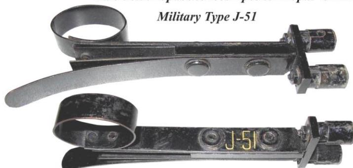
Рис.32. Ключ для корабельного прожектора (США)
