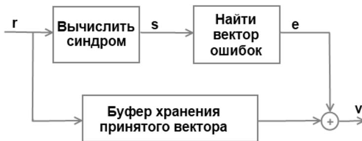
Рис. 1. Упрощенная блок-схема декодера
