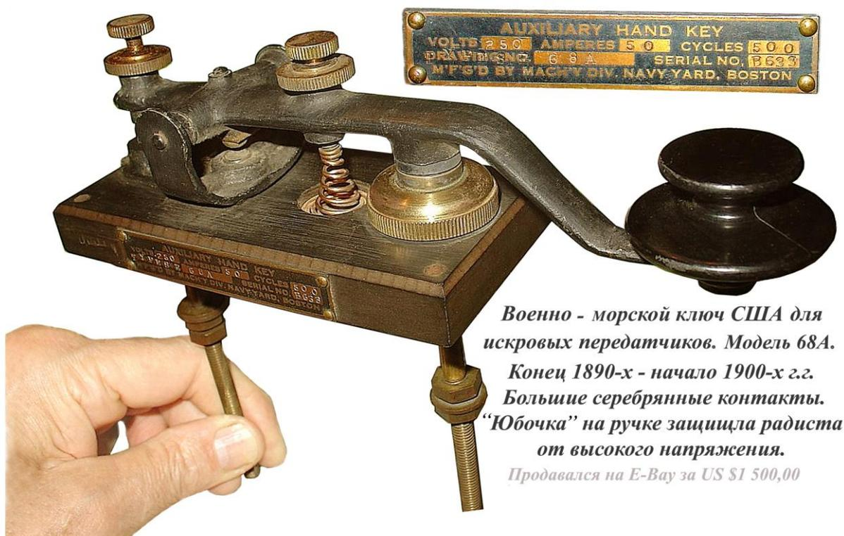
*Военно - морской ключ США для искровых передатчиков. Модель 68А.
