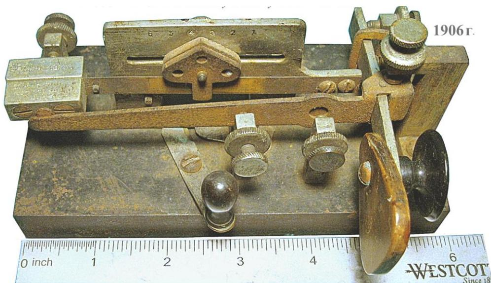
Рис.25. полуавтоматический ключ «Мекограф» Вильяма Кофе
